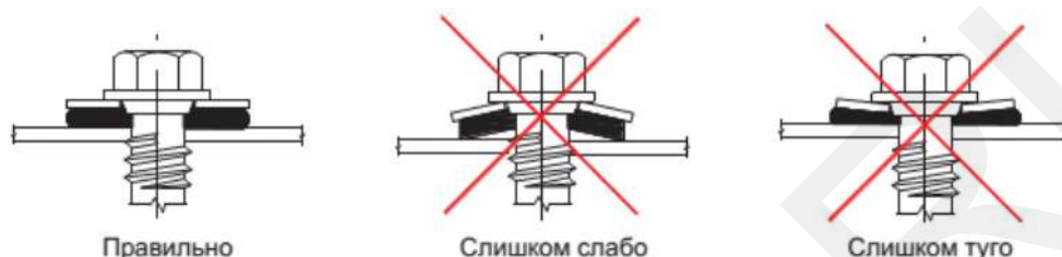
Рис.10. Контроль установки крепежных элементов.
